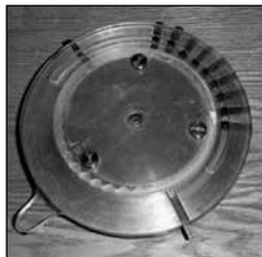
Նկ. 17. Լեոնարդո դա Վինչիի մշակած գումարման սարքի էսքիզով պատրաստված մեքենան
