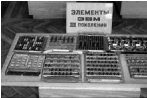
Նկ. 85. 3-րդ սերնդի EC սերիայի ԷՎՄ-ների տարրական բազան
