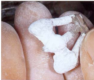
Նկ. 2.2.6. Զուլվածքի ազատում փաթեթանյութից և ավազաշիթով մշակում:
