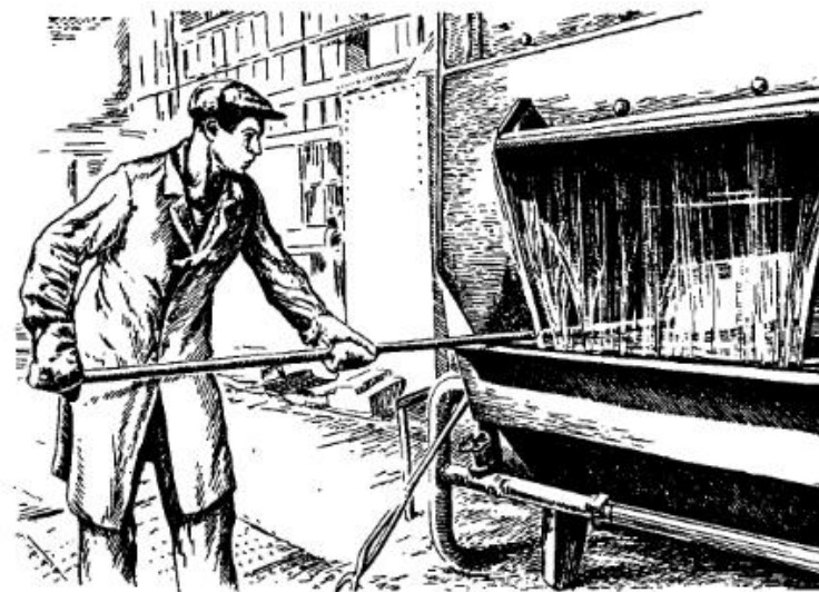
Рис. 104. Водяная завеса перед печью, защищающая рабочего от лучистого тепла.
