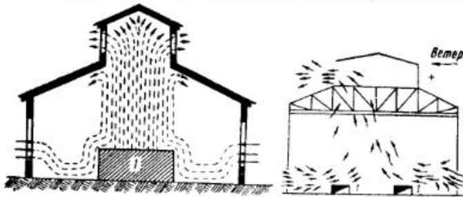
Рис. 97. Аэрация (схема). Воздушные потоки, поступаая в помещения, уносят теплый воздух от нагревательных печей: 1 — источник выделения тепла.
