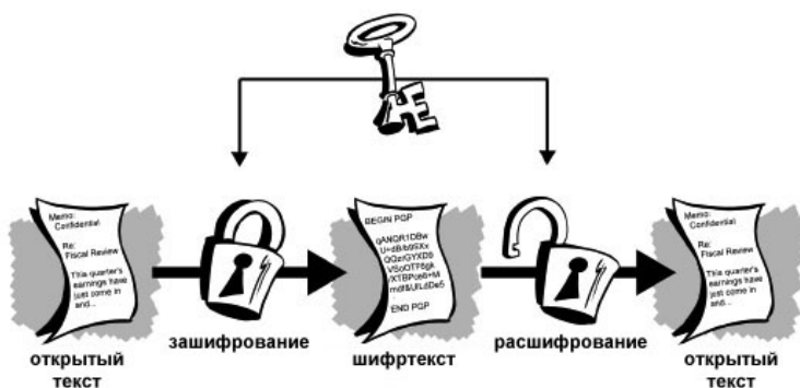
Рис. 35. Процесс применения симметричного ключа
