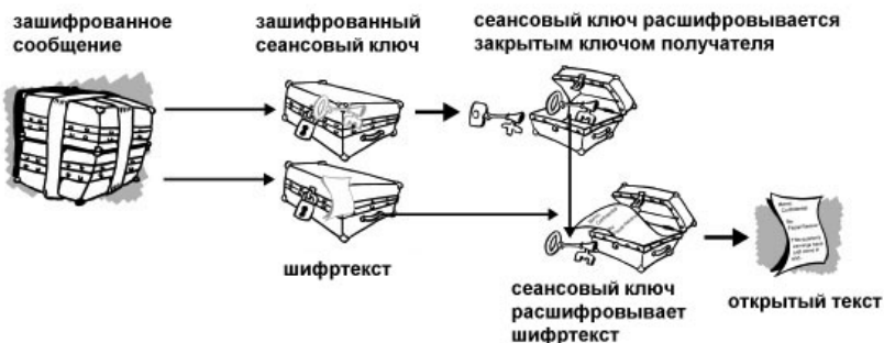
Рис. 40. Схема расшифрования в криптосистеме PGP
