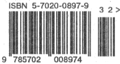
Рис. 14. Дополнительный 2-разрядный код
