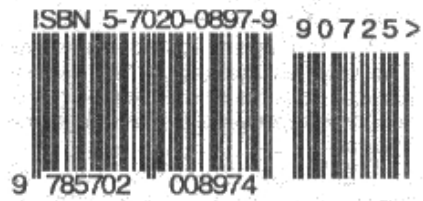
Рис.15. Дополнительный 5-разрядный код
