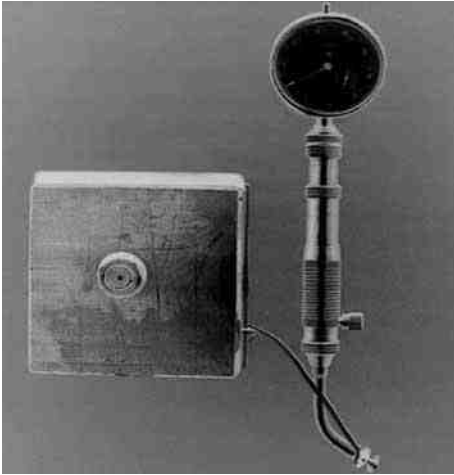
Рис. 2.7. Аппарат для определения податливости слизистой оболочки полости рта
